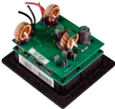
In der zweistöckigen Endstufe sorgen winzige Transistoren (rechts) für die Verstärkung an 0,5 Ohm
