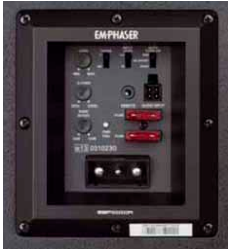
as - odu ist in den ehäuseboden einge assen und nimmt über Stecker und abe bäume ontakt zu Strom, Signa und Fernbedienung auf
